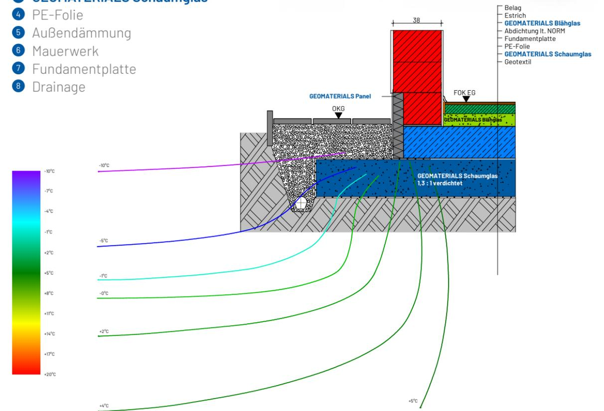
Leichter lastabtragender Schüttstoff mit wärmedämmenden Eigenschaften unter der Bodenplatte
