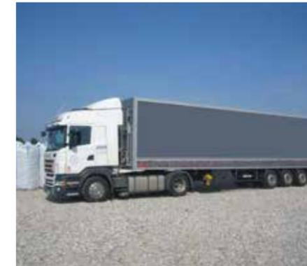
**Anlieferung lose mittels Schubboden-LKW**
