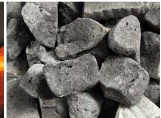
Beim Abkühlen bricht der Kuchen durch Spannungsrisse zu Schaumglas
